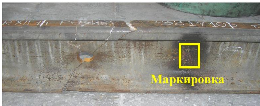
Рисунок 2 - рельсовая проба после копровых испытаний
