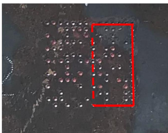
Рисунок 3 - схема выреза микрошлифа в зоне ударно-точечной маркировки (пунктирная линия – поверхность исследования микроструктуры).
